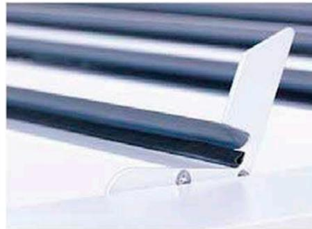
Goma de sellado entre lamas que asegura la estanqueidad de la pérgola y anula el ruido de la vibración de las lamas provocadas por el viento.
